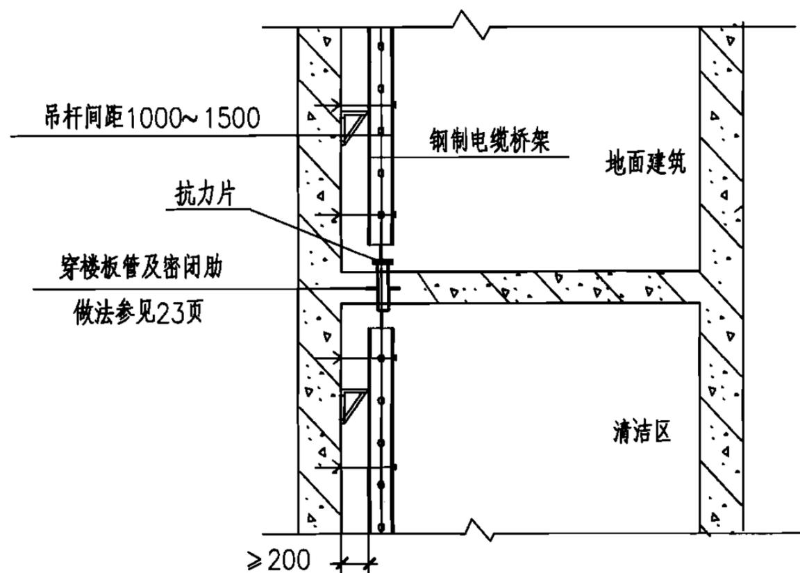
电缆桥架穿越围护结构做法 (三)
