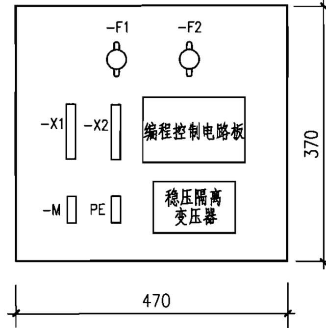
通风方式控制箱底板布置
