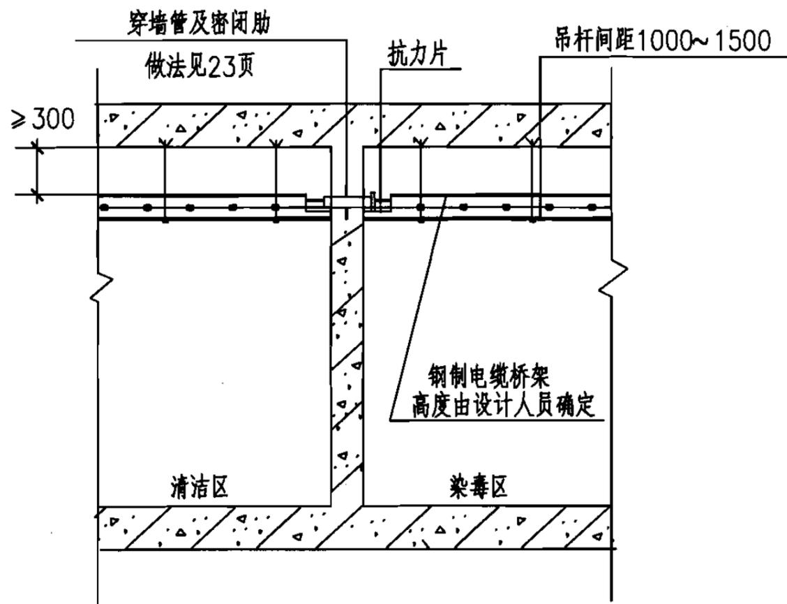
电缆桥架穿越围护结构做法 (一)
