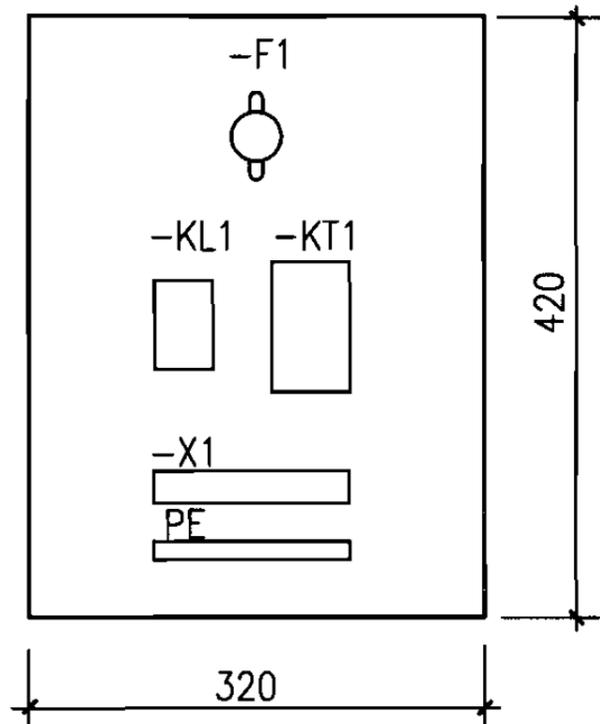
通风方式信号控制箱底板布置
