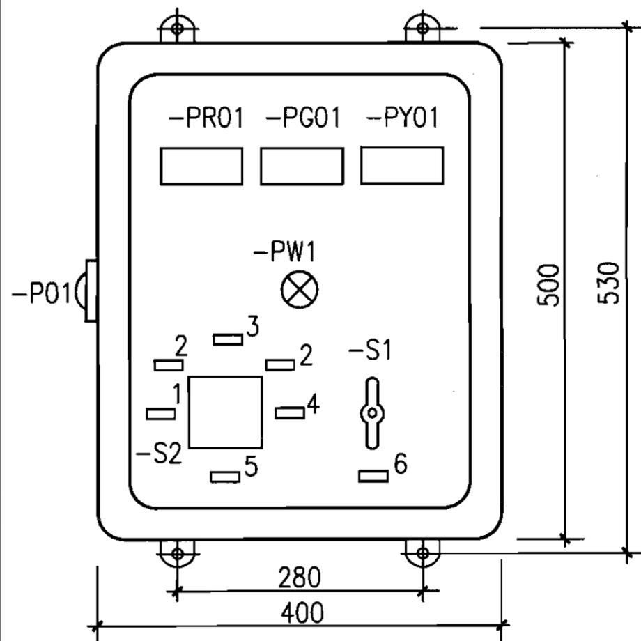
通风方式信号控制箱箱面布置
